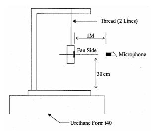
1 METER FROM MICROPHONE TO FAN INTAKE
