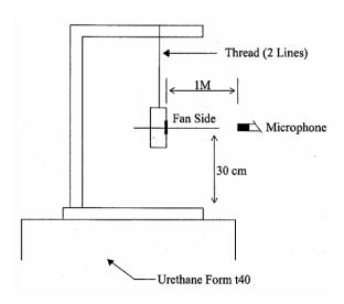
1 METER FROM MICROPHONE TO FAN INTAKE
