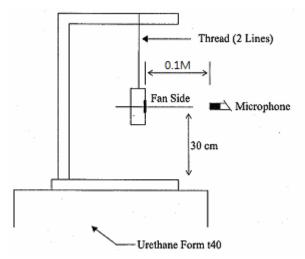
0.1 METER FROM MICROPHONE TO FAN INTAKE
