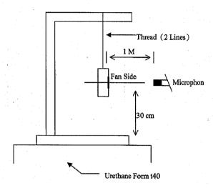
1 METER FROM MICROPHONE TO FAN INTAKE
