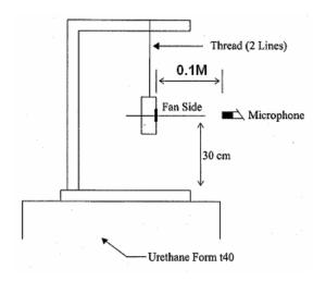
0.1 METER FROM MICROPHONE TO FAN INTAKE
