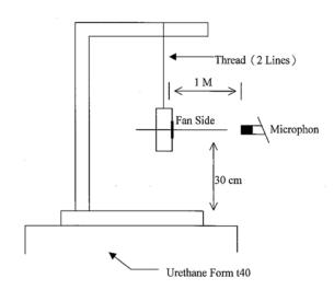
1 METER FROM MICROPHONE TO FAN INTAKE
