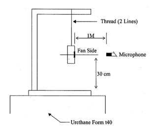
1 METER FROM MICROPHONE TO FAN INTAKE
