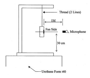
1 METER FROM MICROPHONE TO FAN INTAKE
