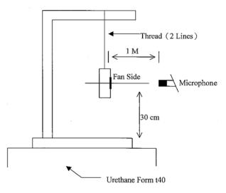
1 METER FROM MICROPHONE TO FAN INTAKE
