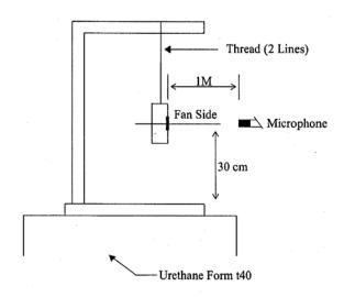
1 METER FROM MICROPHONE TO FAN INTAKE
