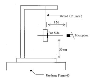
1 METER FROM MICROPHONE TO FAN INTAKE
