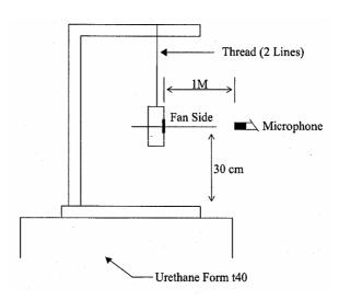
1 METER FROM MICROPHONE TO FAN INTAKE
