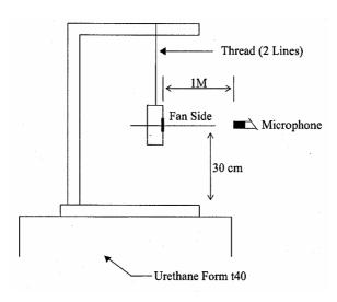
1 METER FROM MICROPHONE TO FAN INTAKE
