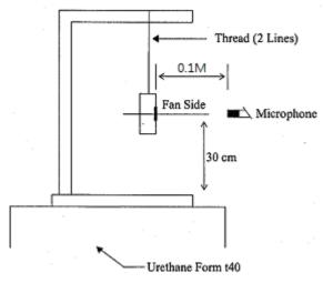
0.1 METER FROM MICROPHONE TO FAN INTAKE
