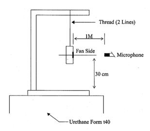
1 METER FROM MICROPHONE TO FAN INTAKE
