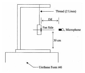
1 METER FROM MICROPHONE TO FAN INTAKE
