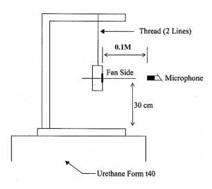
0.1 METER FROM MICROPHONE TO FAN INTAKE
