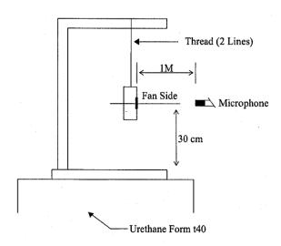
1 METER FROM MICROPHONE TO FAN INTAKE
