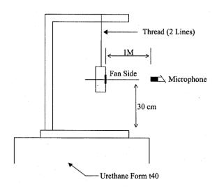
1 METER FROM MICROPHONE TO FAN INTAKE
