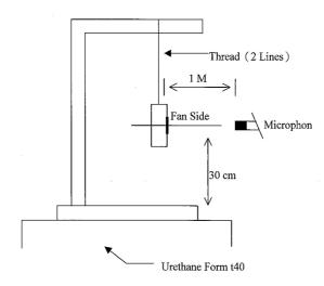
1 METER FROM MICROPHONE TO FAN INTAKE
