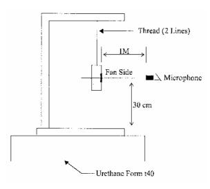
1 METER FROM MICROPHONE TO FAN INTAKE
