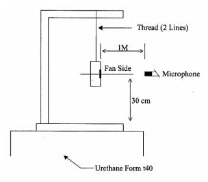
1 METER FROM MICROPHONE TO FAN INTAKE
