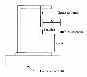
1 METER FROM MICROPHONE TO FAN INTAKE
