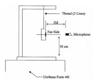
1 METER FROM MICROPHONE TO FAN INTAKE
