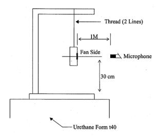
1 METER FROM MICROPHONE TO FAN INTAKE
