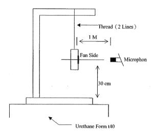
1 METER FROM MICROPHONE TO FAN INTAKE
