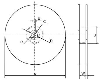
(Unit:mm) Symbol Α В С D Ε W Ø382 max. Dimension (Nominal Ø50 min.  $\emptyset 13 \pm 0.5$ Ø21 ± 0.8  $2.0 \pm 0.5$ 10.0 ± 1.5 Ø330)
