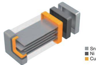
诱电体和内部电极交互叠层构造。利用单片回路的简单设计，拥有更优越的机械强度和更好的频率特性。
