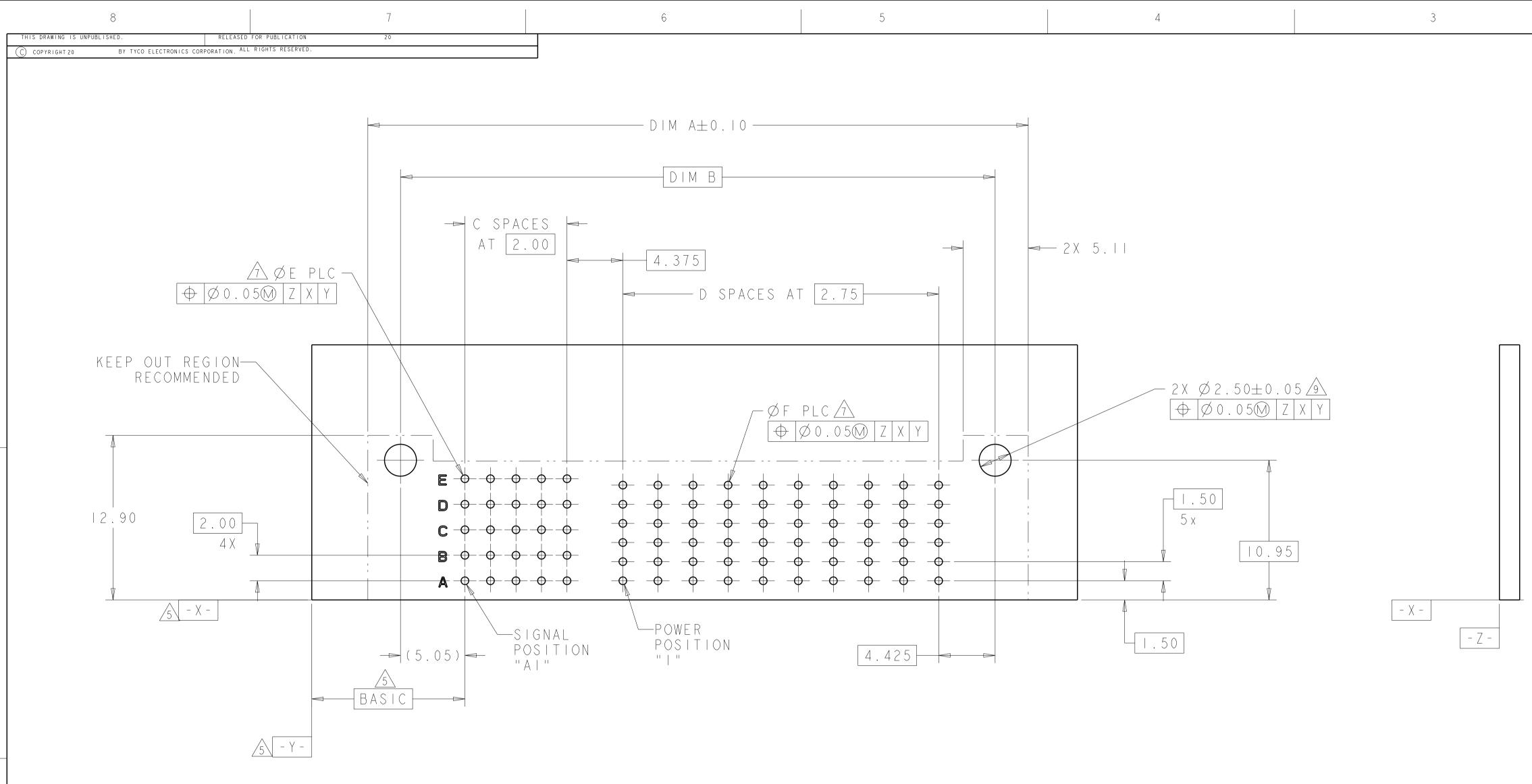
2-1926730-5 SHOWN RECOMMENDED PRINTED CIRCUIT BOARD LAYOUT
