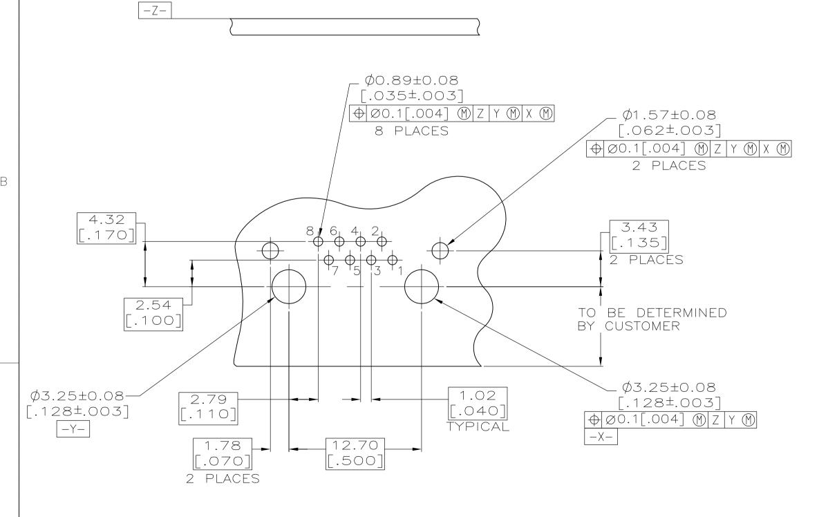
SUGGESTED PRINTED CIRCUIT BOARD LAYOUT (COMPONENT SIDE)
