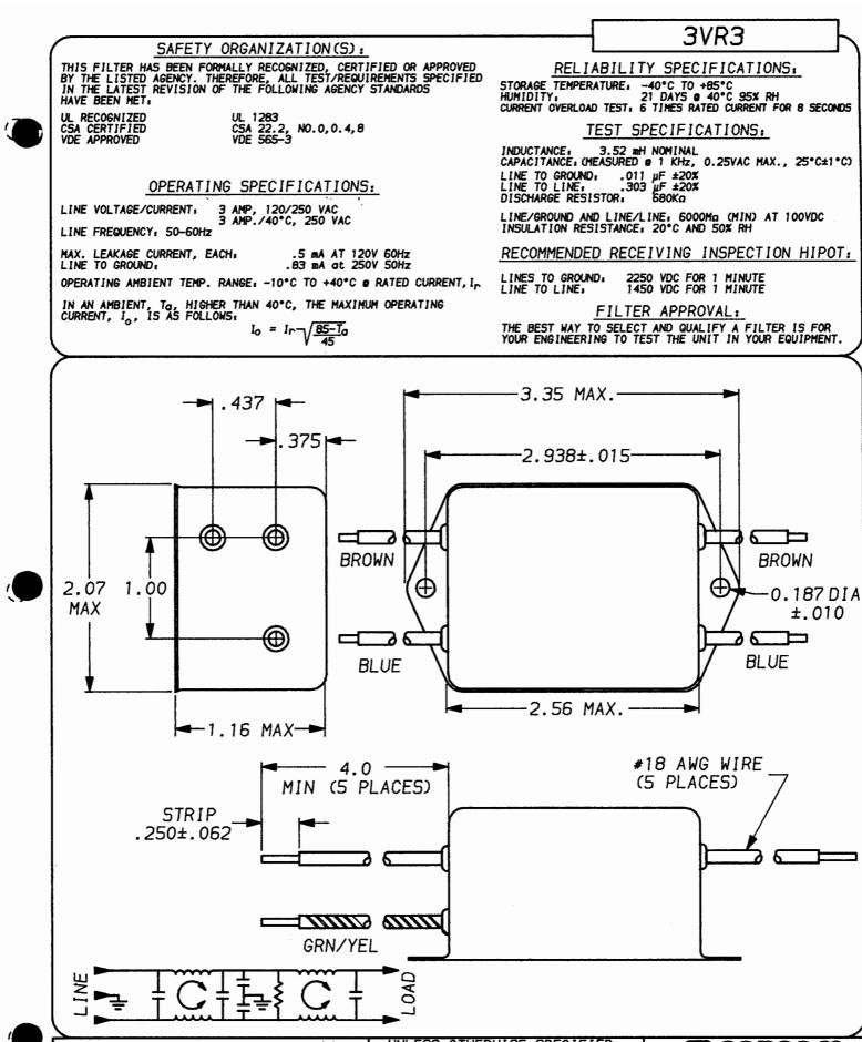
50a CHUMINIM INSERTION LOSS .з .5 . 15 MHz COMMON DIFF
