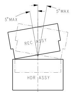
コネクタビッチ方向 CONNECTOR PITCH DIRECTION
