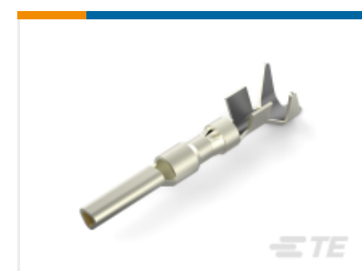
TE Part # 1-794223-0 MINI UMNL2 SCKT 20-16AWG 30AU
