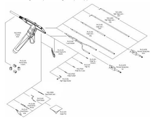
ZS1000, ZS1500, ZS2500 Probe Exploded-View Diagram
