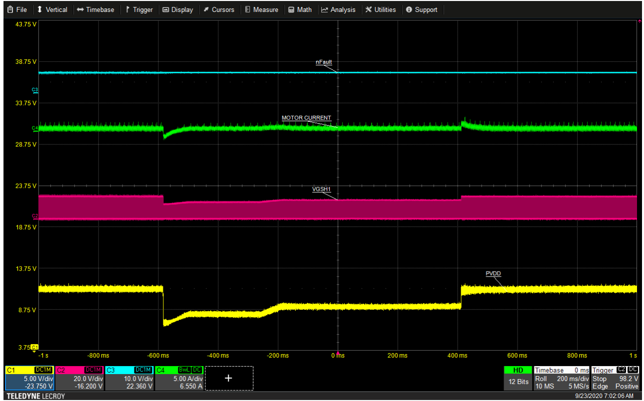
图 8-4. 热启动脉冲期间的驱动器 PWM 运行情况
