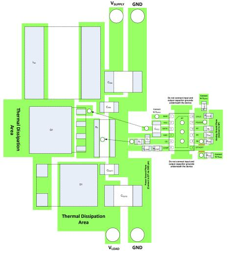
图 12-1. PCB Layout Example 1
