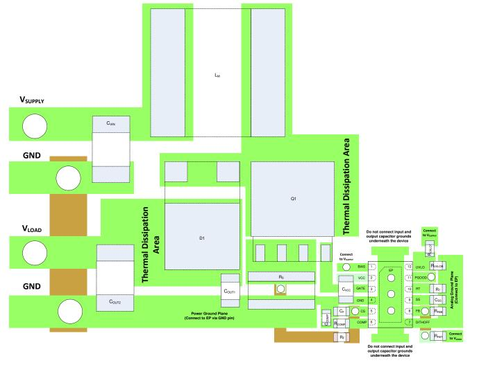
图 12-2. PCB Layout Example 2
