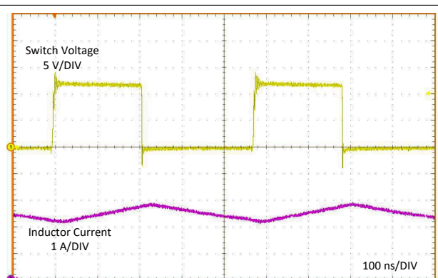
图 8-7. 没有展频的典型 PWM 开关波形， V_{IN} = 12V ， V_{OUT} = 5V ， I_{OUT} = 2.5A ， f_{sw} = 2100kHz
