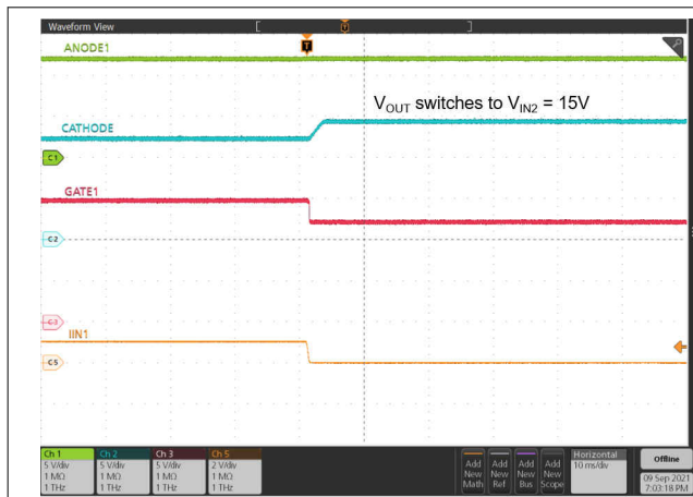
图 9-13. ORing V_{IN1} 到 V_{IN2} Switch Over
