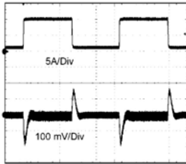
瞬态响应 12 V_{IN} , 5.0 V_{OUT} (1 A 至 10 A 阶跃)
