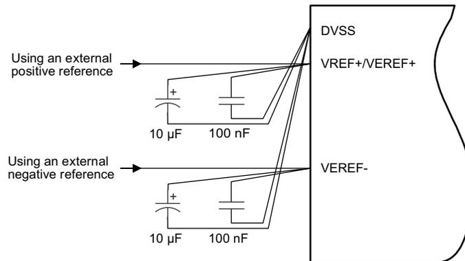
图 10-5. ADC 接地和噪声注意事项
