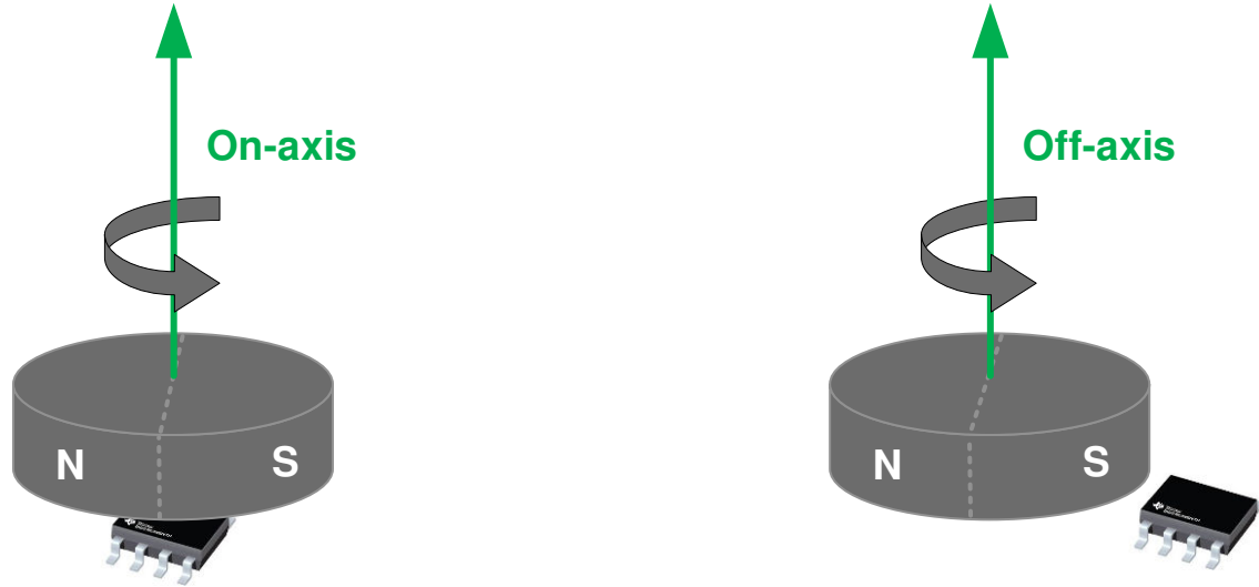
图 8-5. 同轴角度测量与离轴角度测量
