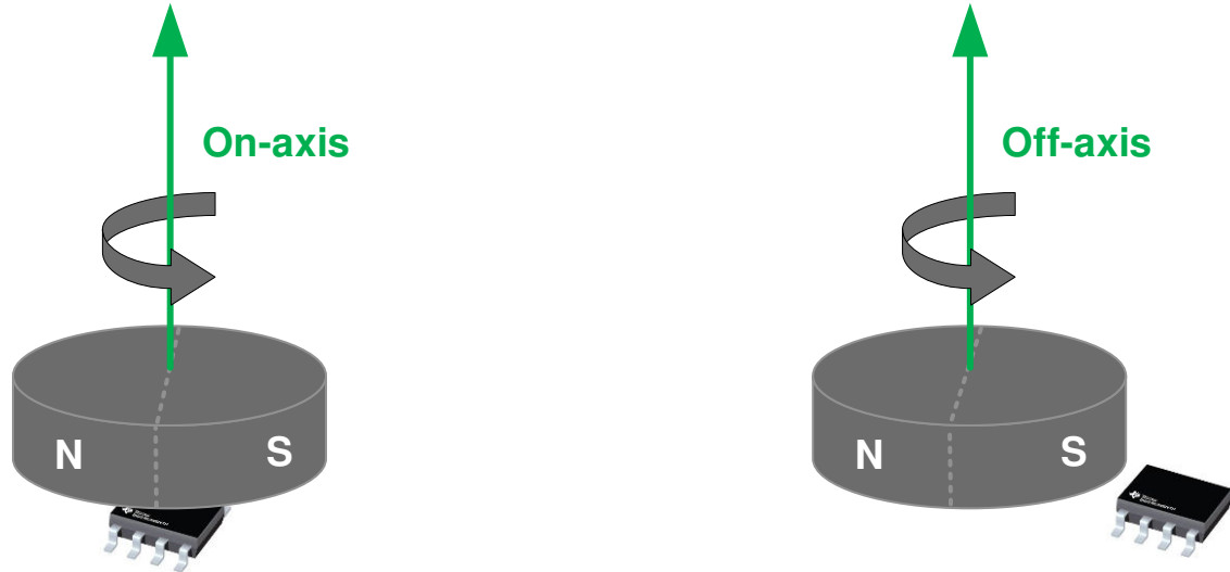
图 8-5. 同轴角度测量与离轴角度测量
