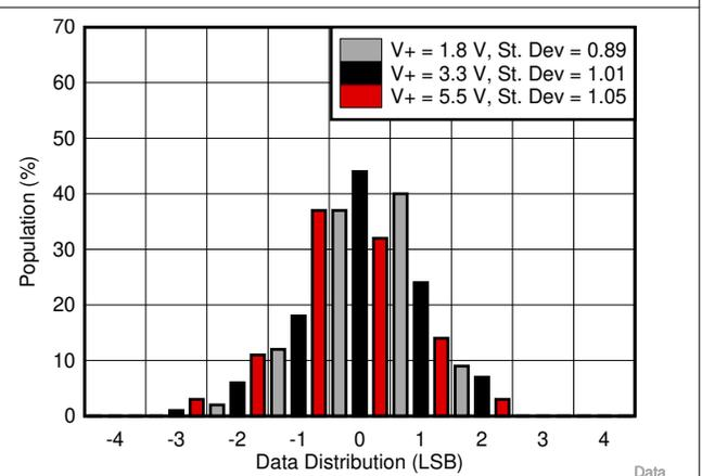
图 6-5. 数据读数分布与电源电压间的关系 (不进行均值计算)
