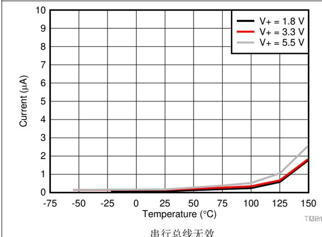
图 6-8. 关断模式下的静态电流
