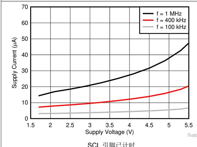
图 6-10. 关断模式下的静态电流
