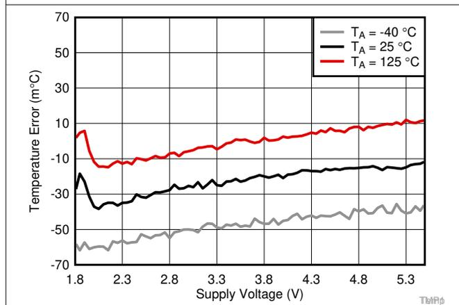
图 6-4. 温度误差与电源电压间的关系
