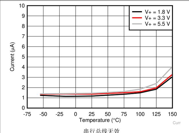
图 6-9. 待机模式下的静态电流
