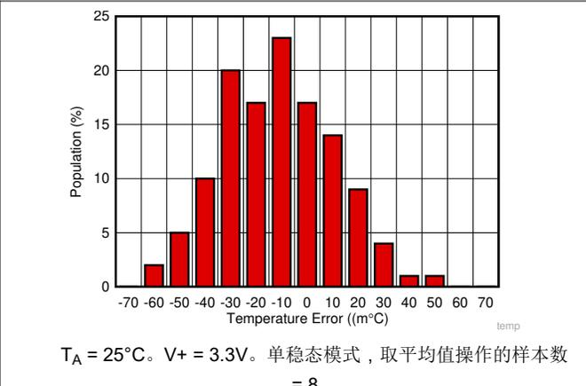
$T_A = 25^\circ\text{C}$ .  $V+ = 3.3\text{V}$ . 单稳态模式, 取平均值操作的样本数 = 8。
