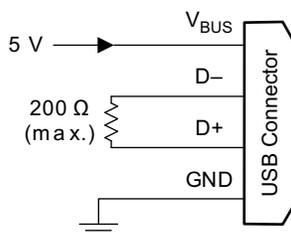
图 10-15. 支持 BC1.2 和 YD/T 1591-2009 的 DCP
