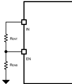
图 10-1. 由使能分压器实施的系统 UVLO
