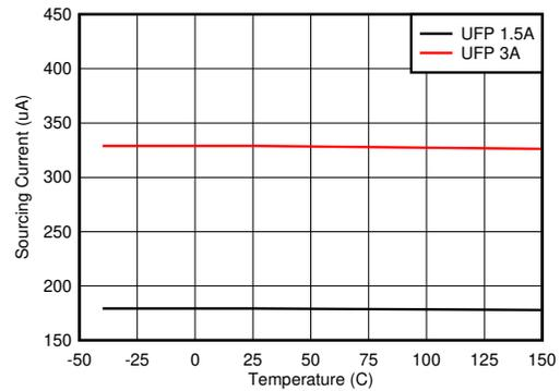
图 8-22. CC 拉电流与结温之间的关系
