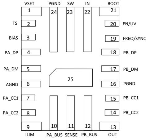
图 7-1. TPS25858-Q1 RPQ 封装 25 引脚 (QFN) 顶视图
