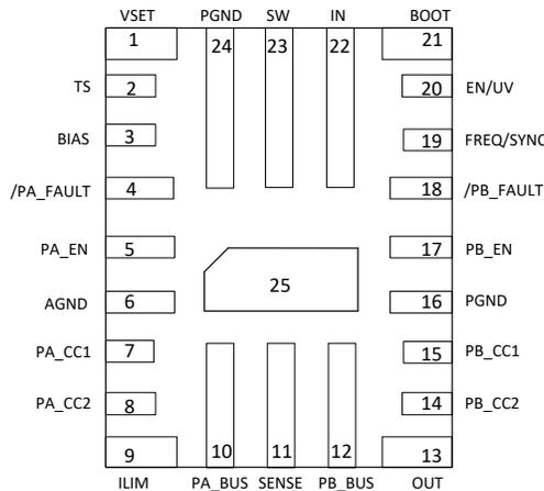
图 7-2. TPS25859-Q1 RPQ 封装 25 引脚 (QFN) 顶视图
