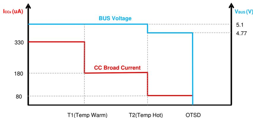
图 10-11. 触发热和高温阈值时 TPS25858-Q1 的行为
