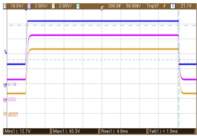
图 51. TPS3840-Q1 Cold-Start Test Pulse
