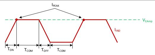
图 9-8. Peak-Current Buck-Boost Operation
