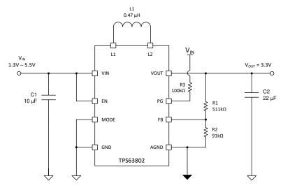
图 10-1. 3.3 V<sub>OUT</sub> Typical Application
