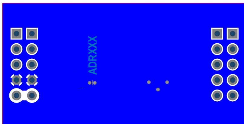
图27. ADRXXX 评估板 PCB 布局 (底层图)
