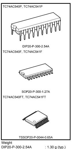
DIP20-P-300-2.54A: 1.30 g (typ.)SOP20-P-300-1.27A: 0.22 g (typ.)TSSOP20-P-0044-0.65A: 0.08 g (typ.)
