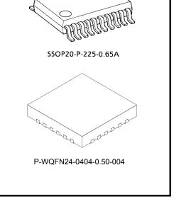
Weight: SSOP20-P-225-0.65A: 0.09g(typ.) P-WQFN24-0404-0.50-004: 0.03g(typ.)
