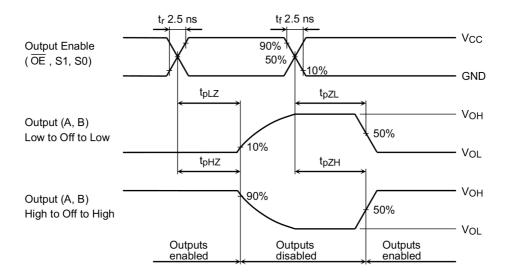
Fig. 11.7.1 AC Waveform tPLZ, tPHZ, tPZL, tPZH
